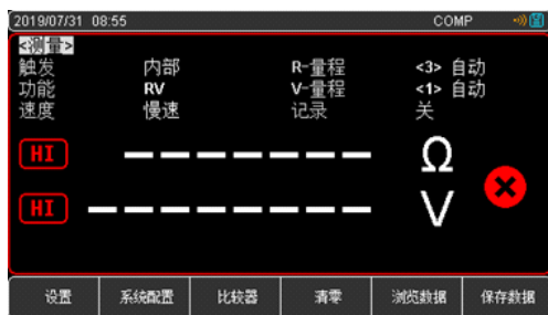
图7-2 -1 比较器开启后的待测量页面
