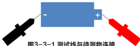
图3-3-1 测试线与待测物连接
