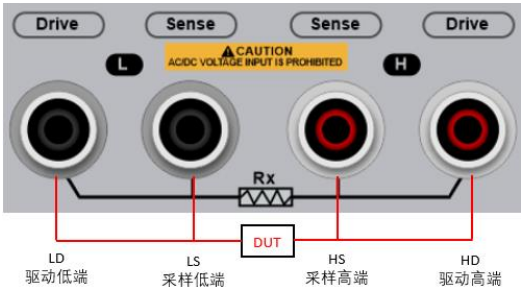
图 4-4 自动化设备测试电缆接线方式示意图
