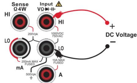
图 2-5 直流电压测量连接示意图
