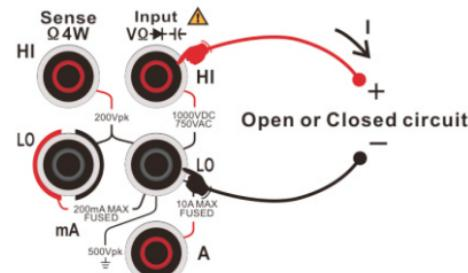
图 2-24 连通测量连接示意图
