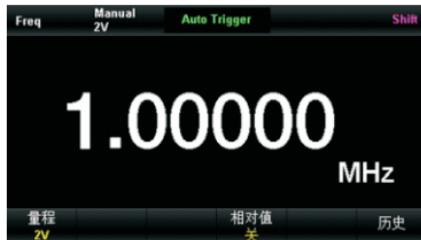
图 2-19 信号频率测量界面
