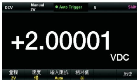
图 2-4 直流电压测量界面
