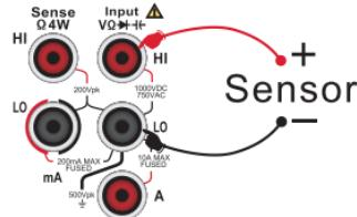
图 2-28 温度测量示意图
