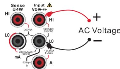
图 2-22 信号周期测量连接示意图
