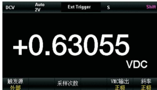
图 2-38 外部触发设置界面
