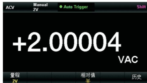
图 2-8 交流电压测量界面
