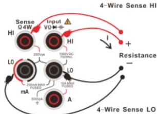
图 2-16 四线电阻测量示意图
