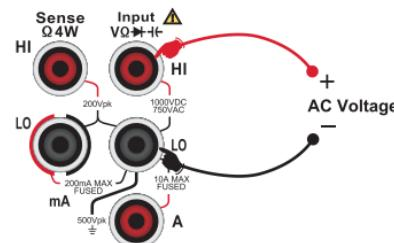
图 2-9 交流电压测量连接示意图
