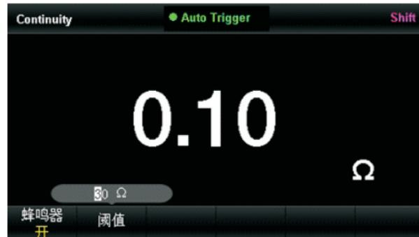
图 2-30 导通测量阈值设置界面
