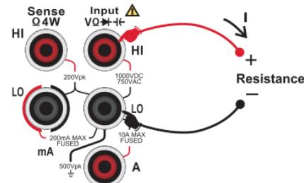
图 2-14 二线电阻测量连接示意图
