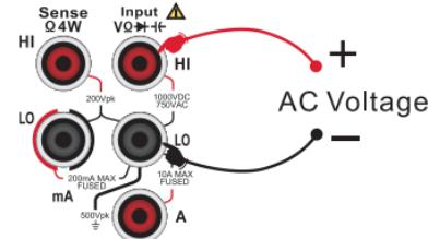
图 2-20 信号频率测量连接示意图
