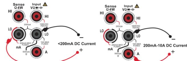
图 2-7 直流电流测量连接示意图
