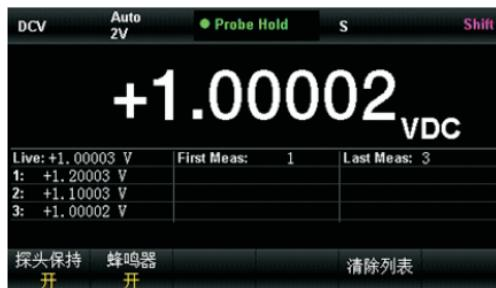
图 3-10 DCV Hold 测量界面
