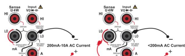
图2-12交流电流测量连接示意图
