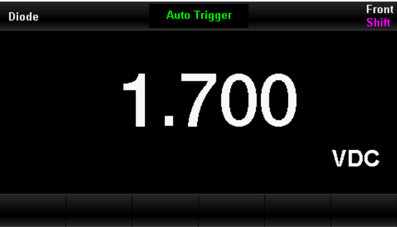
图 2-8 二极管导通电压测量
