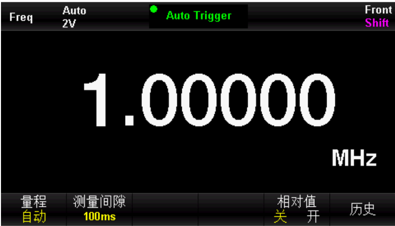
图 2 - 26信号频率测量界面
