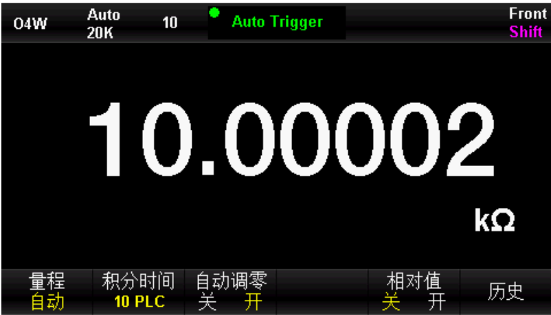
图 2 - 22四线电阻测量界面
