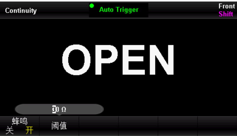
图 2 - 30 连通测量界面
