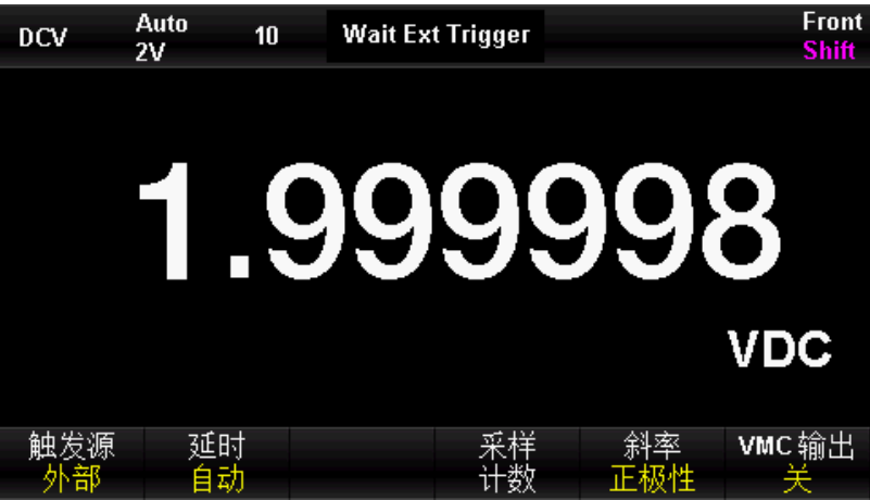
图 2 - 48外部触发设置界面
