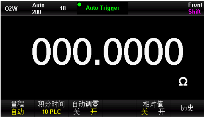
图 3 - 3测试线短路读数
