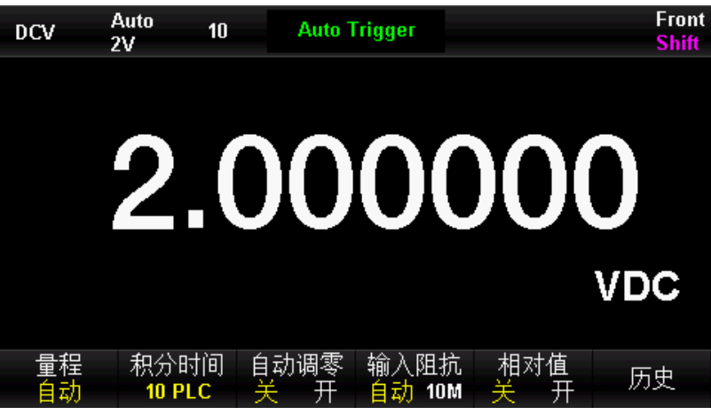
图 2 - 10 直流电压测量界面
