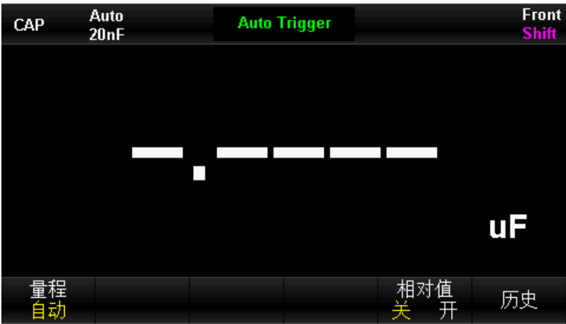
图 2 - 24电容测量界面
