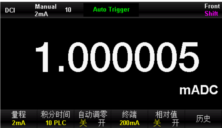
图 2 - 12 直流电流测量界面
