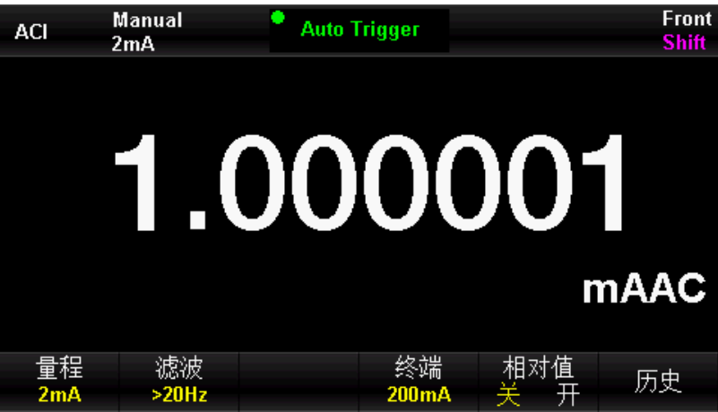
图 2 - 17交流电流测量界面
