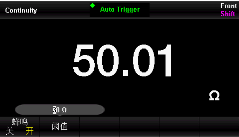
图 2-7 设置短路电阻
