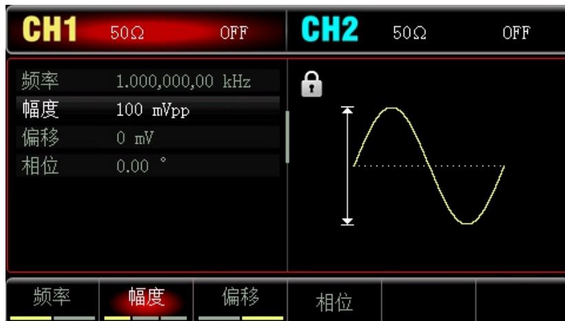
按 **频率** 软键设置频率，使用数字键盘输入900，然后选择参数单位 **Hz**；
