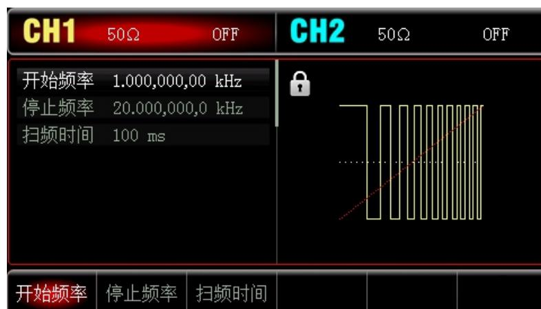
按**开始频率**或**停止频率**软键，再使用数字键盘输入1，然后选择参数单位**kHz**。
