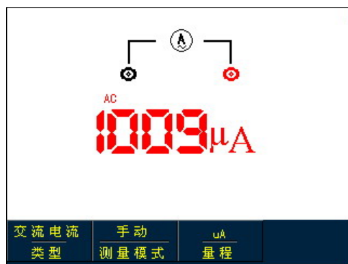
图5-17 小于等于1mA交流电流测量
