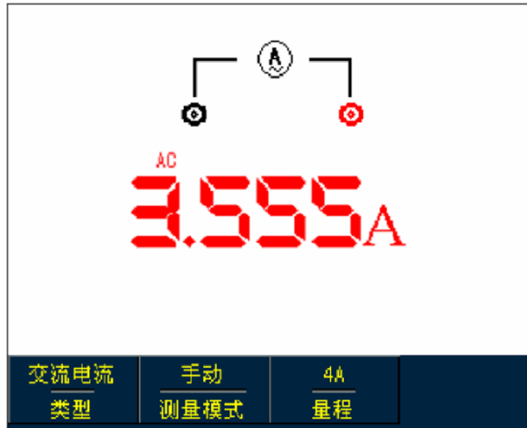
图5-20大于400mA交流电流测量
